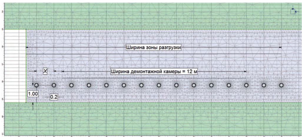
Рис. 2. Расчетная схема для определения расстояния между разгрузочными скважинами Fig. 2. Computational scheme for finding spacing of destress holes
