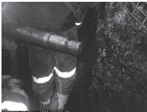
Рис. 1. Извлечение угольного керна из керноотборника
