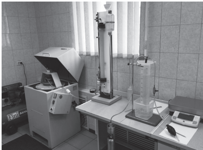
Рис. 4. Измерение объемов газа, выделяющегося при измельчении пробы угля в герметичной мельнице
