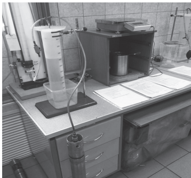
Рис. 3. Установка для измерения объема выделяющегося газа при атмосферном давлении в лаборатории
