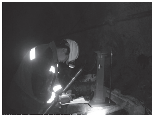
Рис. 2. Установка для измерения выделяющегося газа V_1 в шахте
